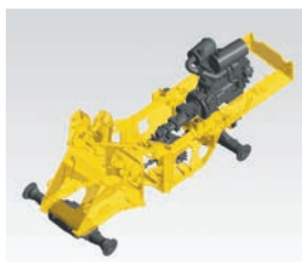
Robuster, verwindungssteifer Rahmen
