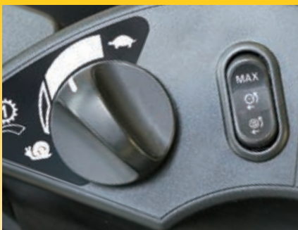
Stufenlose Geschwindigkeitsregelung mit variabler Kriechganggeschwindigkeit (links) und Schalter für einstellbares Zugkraftkontrollsystem (rechts)
