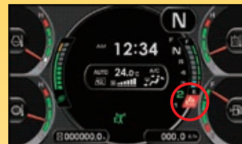
AdBlue®-Füllstandanzeige und Nachfüllhinweis
