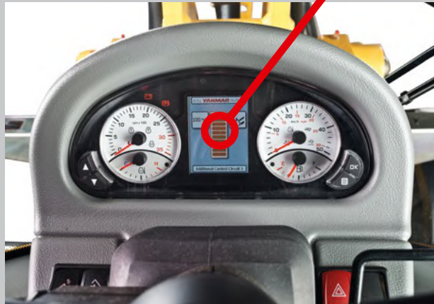
Setup-Menü für die Einstellung der Einheiten wie Geschwindigkeit, Temperatur und weitere Möglichkeiten.
