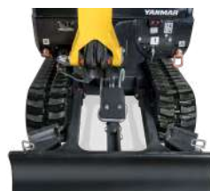
Eingefahrener Unterwagen: 980 mm
