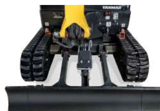
Ausgefahrener Unterwagen: 1380 mm
