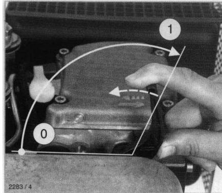
Bringen Sie den Drehzahlverstellhebel 1 (linkes Bild) nach Bedarf in START oder ½-START. Vergewissern Sie sich, daß der Stop-Hebel auf der rechten Seite der Maschine nicht auf STOP steht, sondern ganz entgegengesetzt ist. Lassen Sie den Dekompressionshebel in der Stellung „0“ (siehe rechtes Bild)
