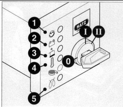
Stecken Sie den Startschlüssel ein und drehen Sie auf Stellung I. Die Ladeanzeigeleuchte „2“ und die Öldruckanzeige „3“ leuchten auf.
