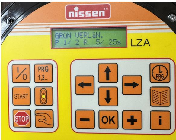
Anlage ist in Betrieb und zeigt den Programmablauf an
