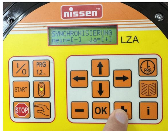
Taste „OK“ drücken um Synchronisation (Übertragung) zur Slaveampel zu starten (Slaveampel muss eingeschaltet sein)
