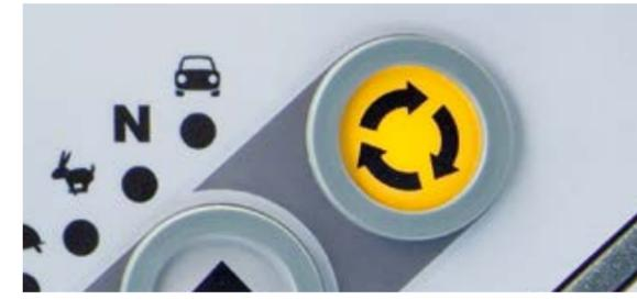
Mit nur einem Druck auf die Execute-Taste wird die AutoSet Basic Umsetzfunktion gestartet.
