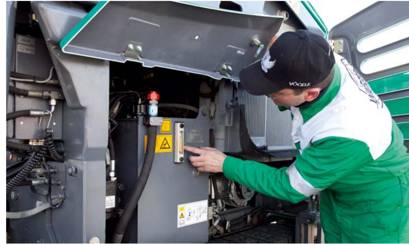
Das einheitliche Servicekonzept der „Strich 3“-Fertiger ermöglicht schnelle, unkomplizierte Wartung. Alle Servicepunkte an der Maschine sind mittels großer Wartungsklappen leicht zugänglich.
