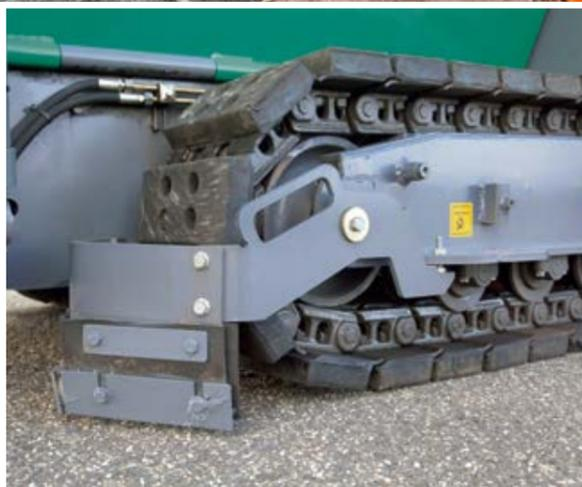
» Leistungsstarke Einzelantriebe, die direkt in den Turas der Raupen integriert sind, erreichen eine maximale Umsetzung von Antriebsleistung in Einbaugeswindigkeit.
