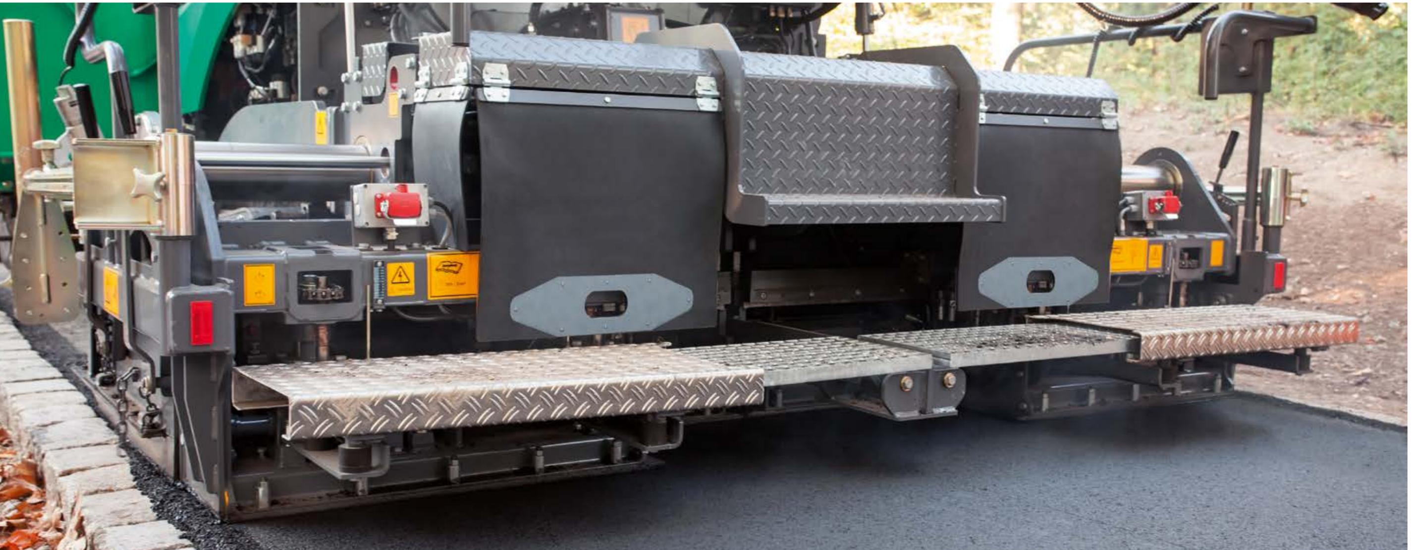
**DIE AB 340 TV** ist die perfekte Einbaubohle für den SUPER 1300-3i. Sie verfügt über eine Grundbreite von 1,8 m und ist hydraulisch bis auf eine Breite von 3,4 m ausfahrbar. Mit Verbreiterungen lässt sie sich bis auf eine maximale Einbaubreite von 5,0 m erweitern.
